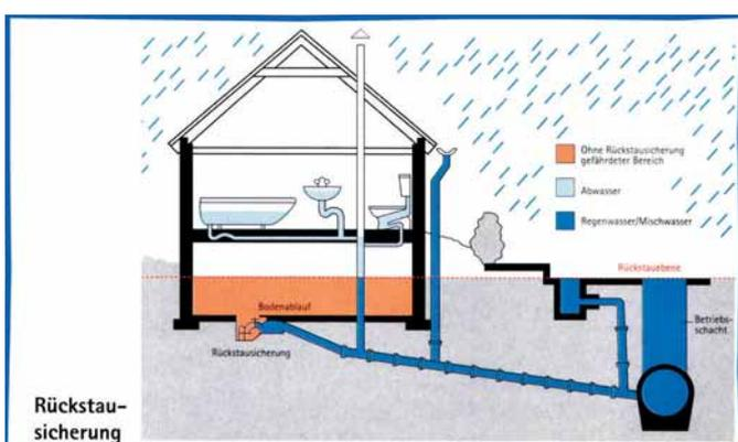
Abb. 1: Rückstausicherung
